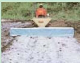
逆に、石灰の大量散布をする場合は、肥料を地面近くに落下させる方式で風の影響が少ないライムソワーが適しています。ブロードキャスターで粉状肥料をまくときは、防風カバーが別売りでありますのでご利用ください。
