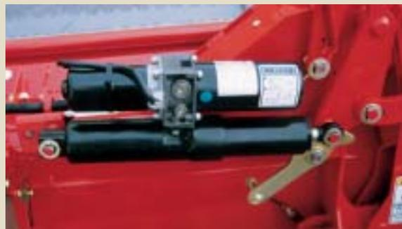
リモコン仕様の開閉は電動ミニモーションを採用し、スムーズに静かな開閉がおこなえます。またミニモーションでは開閉時間が長くなる傾向がありますが、リンク、シリンダストローク量などを工夫し開閉時間の短縮をしています。
