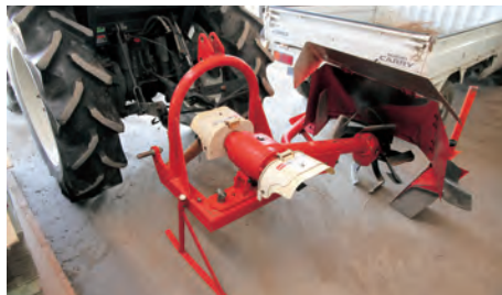
▲畑の明渠排水溝作り リターンディッチャ RD251
