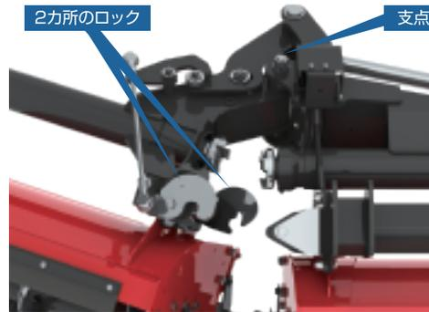
左右の作業部を、支点と前後2カ所のロックで強力に連結し、強い構造体を実現しました。
