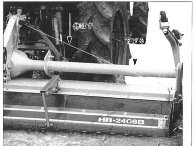
(5) ⑬⑭⑮⑯はドライブハローを水平に戻し、サイドレーキを開き、最後に残ったところを作業します。
