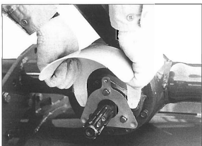
(2)ジョイントカバーのチェーンを、固定した箇所につなぎ、止めます。油圧を上下しても引張られないようたるみを持たせます。
