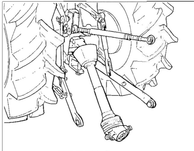
② カプラを、トラクターのトップリンクに取付けます。
