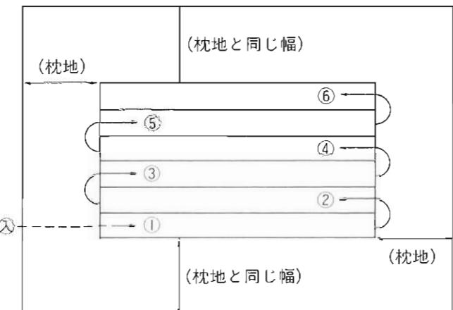
①トラクター旋回用の枕地として約3行程分をとり、側方にも枕地と同じ幅を残し、ほ場の長辺をまっすぐ耕します。
