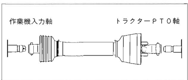
入力軸カバーを外さなくとも、ジョイントは付けられます。点検するときは、2カ所のRピンを抜き、上に上げます。
