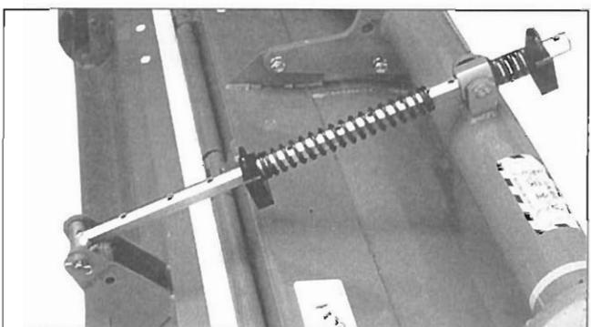
石の多い圃場や粘湿田では、抑えバネをフリーにし、上方スプリングエンドを下げて、均平板を表面から浮かせ、均平板の損傷や土溜りを少なくして使用してください。
