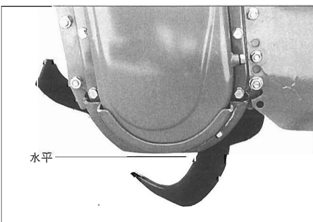
ケースガードの下端が水平になるように、ロータリーの前後の角度を調節します。
