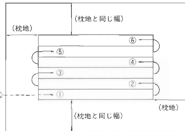
①トラクター旋回用の枕地として約3行程分をとり、側方にも枕地と同じ幅を残し、ほ場の長辺をまっすぐ耕します。
