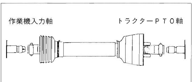
入力軸カバーを外さなくとも、ジョイントは付けられます。点検するときは、右側1カ所のRピンを抜き、上に上げます。
