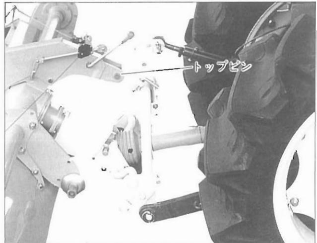
トラクターの油圧を下げて、カプラのトップフックをロータリーのトップピンの下へくぐらせます。トラクターとロータリーの中心が合うまで繰り返してください。
