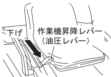
**4** ローピンガイドからカプラが抜け、トップピンからトップフックが外れたのを確認します。
