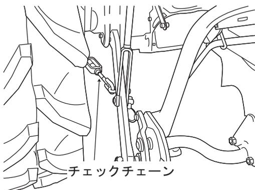
**6** トップリンクの長さは、ローワーピンの地上高が下図のとき、カプラが垂直になるように調整します。
