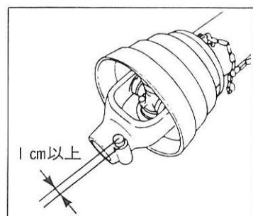
3セットの場合は、広角ジョイントを取付けます。必ず広角側をトラクターのPTO軸へセットしてください。
