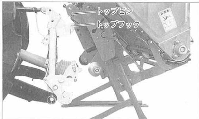
(3)ゆっくりトラクタの油圧を上げて、トップフックでトップピンをすくい上げます。
