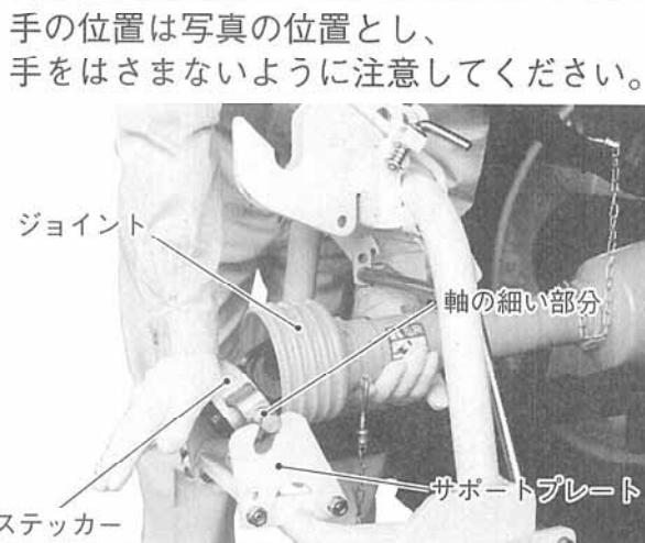
(注)ジョイントが長くてサポートプレートに取付けてできないときは、無理に取付けないでください。長いときは、切断して使用してください。無理に取付けると、トラクタ、作業機を破損させる原因になります。
