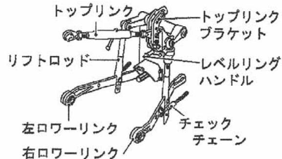
特殊3点リンク式のロータリーを使用している場合には、トップリンクの連結部を外し、標準3点リンク用の長いトップリンクを使用してください。
