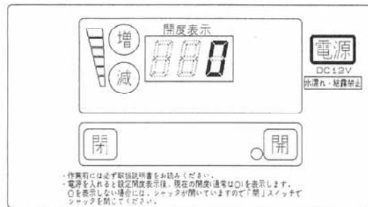
(2) 「増」ボタンまたは「減」ボタンを押して決められた開度に設定してください。長押しすることで高速設定できます。1～36（全開）まで設定することができますが、開度ラベルに基づいた条件で設定してください。
