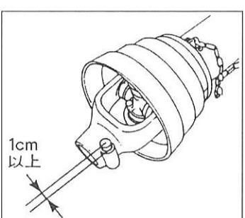
(2)ジョイントカバーのチェーンを、トラクターとフレールモアの動かない場所につなぎます。
