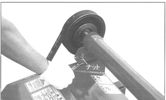
④ベルトの張りは、指で押して1cm位へこむ程度に調節します。
