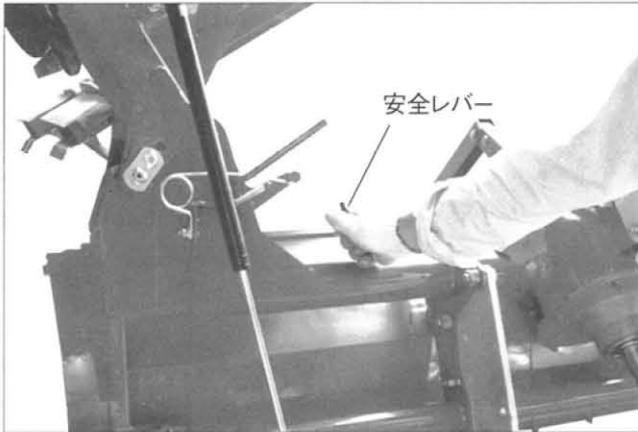
左右作業部のロックバーがフレームの切欠ミゾに入るまで上げます。
