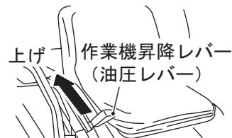
作業機のローワーピンガイドがカプラに入ります。4セットの場合は、同時にジョイントが自動装着されます。
