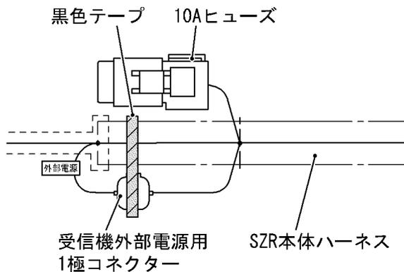
**3** 受信機外部電源用1極コネクタの接続を外します。
