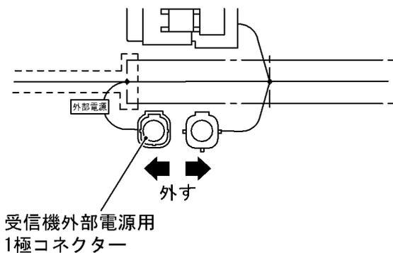
**4** 受信機外部電源ケーブル蓋付の1極コネクタの蓋を外します。
