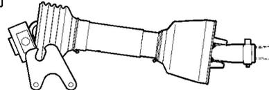
ジョイントが長くてサポートプレートに取付けできないときは、長い分を切断します。「5.3.3 切断方法」(29 ページ)を参照してください。
