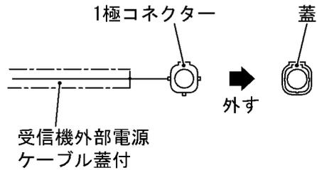
**5** 受信機外部電源ケーブル蓋付の1極コネクタとSZR本体ハーネスの受信機外部電源用1極コネクタを接続します。
