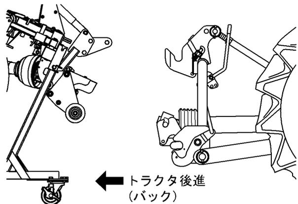
**6** トラクタの作業機昇降レバー (油圧レバー) を下げて、カブラのトップフックを作業機のトップピンの下へくぐらせます。
