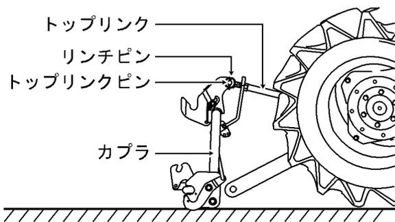
**4** 左右のロワーリンクをカブラのロワーピンに取付けます。
