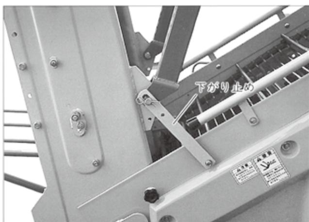
守らないと誤操作でコンベヤーが突然下がり傷害事故や機械の損傷につながる恐れがあります。
