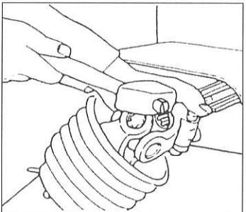
ロックピンが1cm以上出ていると、確実にロックされています。(フレールモア側)
