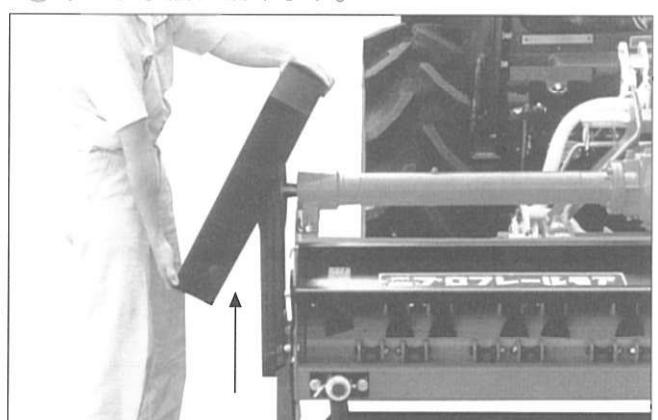
④ベルトカバーを水平にして持ち上げると外れます。
