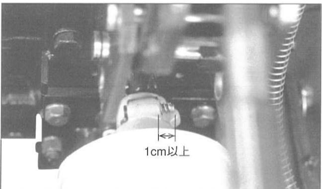
ジョイントの取付方向は、ワンウェイクラッチ側をトラクター側のPTO軸に取付けます。
