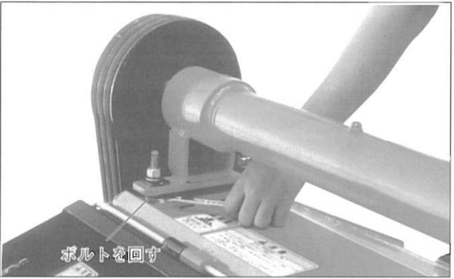
③ベルトの張りは、指で押して1cm位へこむ程度に調節します。
