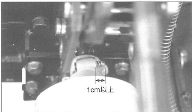
ジョイントの取付方向は、トラクターマークのある方をトラクター側のPTO軸に取付けます。
