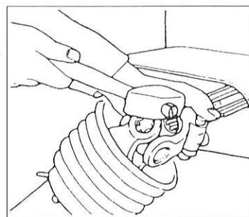
ロックピンの頭が1 cm 以上出ているれば確実にロックされています。
