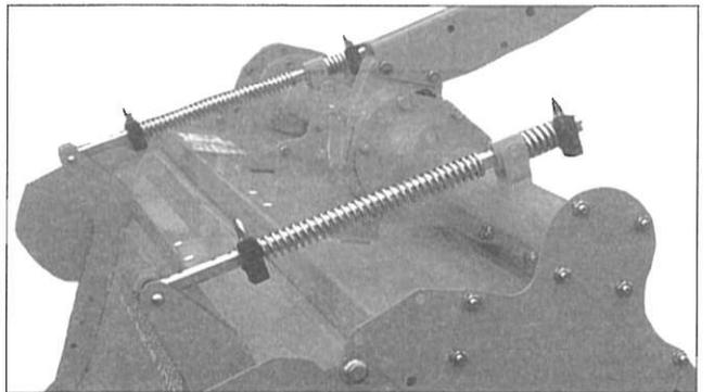
石の多いほ場や粘湿田では、押えバネをフリーにし、上方スプリングエンドを下げて、均平板を表面から浮かせ、均平板の損傷や土溜りを少なくして使用してください。
