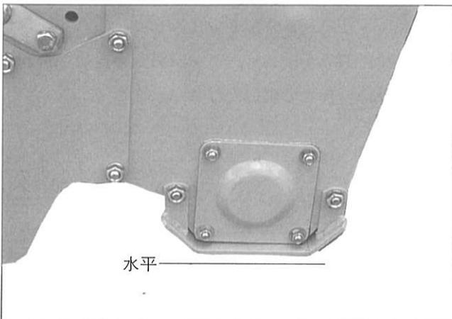
トガードの下端が水平になるように、ロータリーの前後の角度を調節します。
