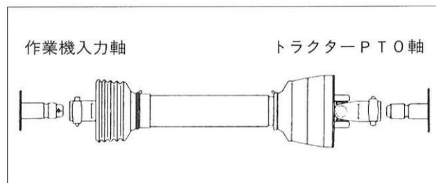
入力軸カバーを外さなくても、ジョイントは付けられます。取付け、点検するときは、下図のRピンを抜き、上に上げます。
