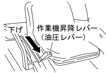
7 トラクタの作業機昇降レバー（油圧レバー）をゆっくり上げて、トップフックでトップピンをすくい上げます。
