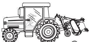
3 ジョイントをいっぱいに縮め、ジョイントの先端と作業機の入力軸との間に10mm以上の隙間があれば、そのままロックピンを押しながらはめ込み、取付けます。
