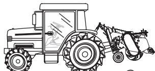
5 トラクタを作業機の中心に合わせ、まっすぐバックさせます。
