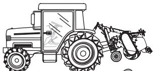
7 トラクタの駐車ブレーキをかけ、PTO 変速レバーを「中立」の位置にし、エンジンを停止します。また、エンジンを始動できないようにキーを抜き、作業者が携帯します。
