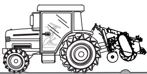
3 ジョイントをいっぱいに縮め、ジョイントの先端と作業機の入力軸との間に 10 mm 以上の隙間があれば、そのままロックピンを押しながらはめ込み、作業機の入力軸に取付けます。
