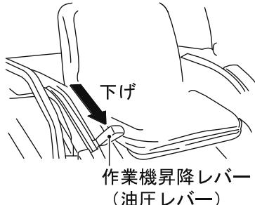
2 トラクタの駐車ブレーキをかけ、PTO 変速レバーを「中立」の位置にし、エンジンを停止します。また、エンジンを始動できないようにキーを抜き、作業者が携帯します。
