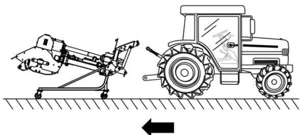
**3** トラクタの駐車ブレーキをかけ、PTO 変速レバーを「中立」の位置にし、エンジンを停止します。また、エンジンを始動できないようにキーを抜き、作業者が携帯します。
