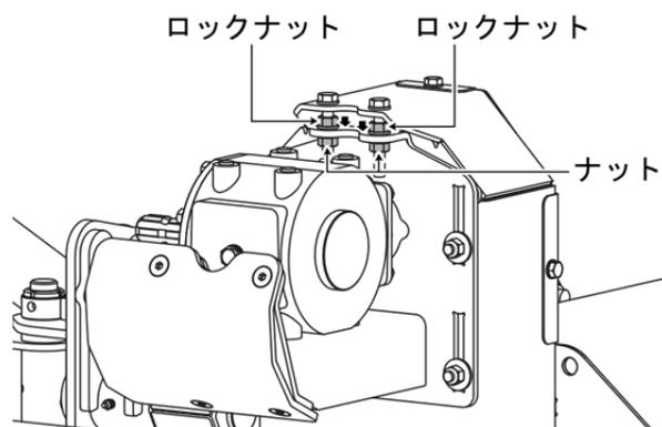
**5** すでにゆるめたナット（4箇所）を締付けて固定します。
