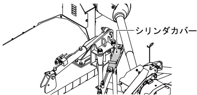
作業時には、必ず横スライド用油圧シリンダからシリンダカバーを取外し、ヒッチアームのスタンド取付け部に取り付けてください。
