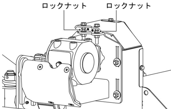
**3** 調節用ボルトの頭を反時計回りに交互に回してミッションを下げ、Vベルトの張りをゆるめます。
