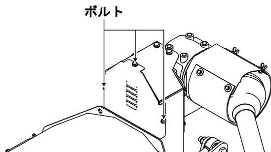
**3** ボルト（3本）を外して、下側のフタを取外します。
