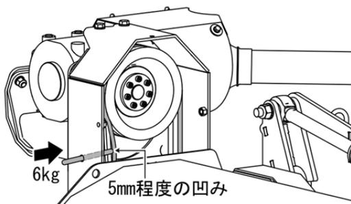
**4** 調節用ボルトのロックナット（2箇所）を締めます。
