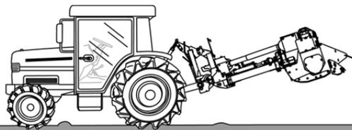
ジョイントが長くてサポートプレートに取付けできないときは、長い分を切断します。「5.3.3 切断方法」(26 ページ)を参照してください。
