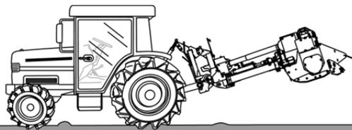
**3** 調節用ボルトの頭を時計回りに交互に回してミッションを引き上げ、Vベルトの張りを調整します。
