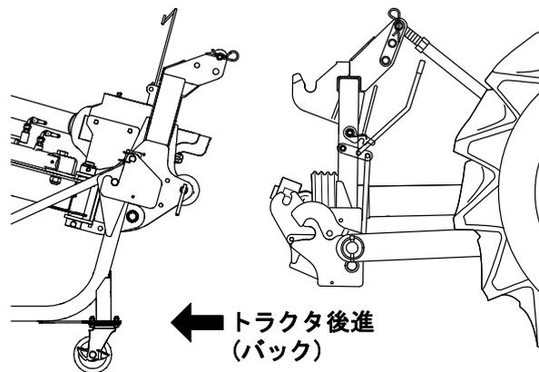
**6** トラクタの作業機昇降レバー (油圧レバー) を下げて、カプラのトップフックを作業機のトップピンの下へくぐらせます。
