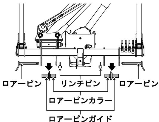
**5** 作業機の左ヒッチアームにトラクタの左ローリンクを取付けます。
