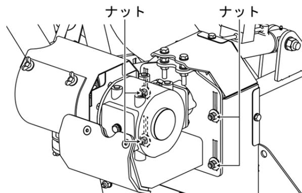
**2** 調節用ボルトのロックナット（2箇所）をゆるめます。
