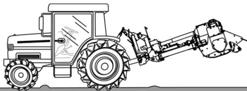
**6** トラクタの作業機昇降レバー（油圧レバー）を操作して、ジョイントを取外しやすい位置（角度）に、作業機を調整します。
