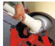
スパウトはボルトを緩めて簡単に着脱できます。
