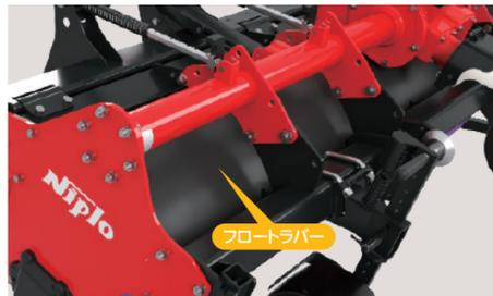
耕うん部カバー一部に放てきされる土塊により絶えず耕うん部カバー内側の土を落とす「フロートラバー」を採用。フロートラバー裏には丸形ゴム受けバーを採用し土の付着を軽減しました。
