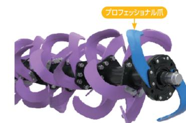
両端の爪は他の爪に比較して早く摩耗する傾向があります。プロフェッショナル爪は外溶着でG加工(溶着部)を基部まで伸ばし両端爪の摩耗を抑えます。(SKDシリーズ標準装備)
