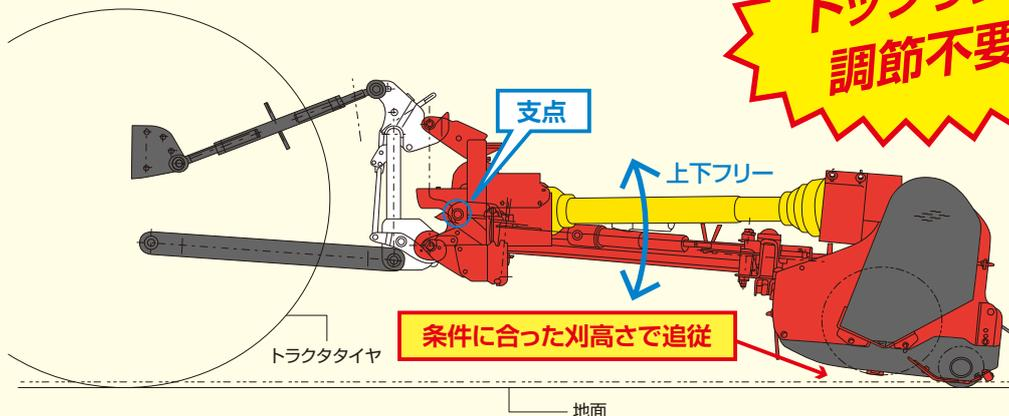
アゼの上面や土手の傾斜面などの作業姿勢が変化する時の草刈をする場合も、トラクタのポジションレバーを操作するだけで適正な刈高さを維持します。
