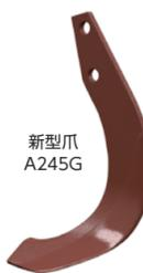
新型爪 A245G を採用。爪の母材を2段カット形状にすることで特殊合金の溶着量を増やし、従来爪と比較して耐摩耗性が約1.3倍になっています。(当社試験データに基づく)
