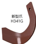
新型爪 H341G を採用。摩耗しやすい爪の作業部の厚みを増やし、従来爪と比較して耐摩耗性が約1.7倍になっています。(当社試験データに基づく)
