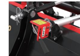
ガスプリングの作用で均平板持ち上げ時の負担が約50%軽減されます。
