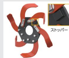
広幅形状で石に強く、溶着加工により耐摩耗性に優れたBA110G爪を標準装備。更に、爪フランジの耕うん爪取付部後ろにストッパーを設け、石による耕うん爪・ボルトの折れを防ぎます。
