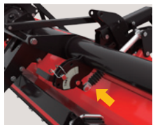
HL30の加圧機構 強・弱・OFFの 3段階調節
