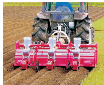
BUR2210H-4L + けん引型シーダー3条 3畝成形同時播種
