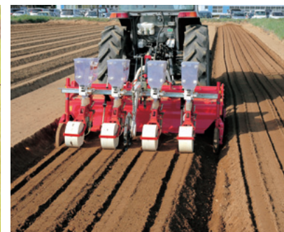
APU1710H-4S + けん引型シーダー4条 平高畝立て4条播種作業
