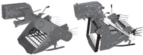
独自のコンベア技術により、傷つけることなく収穫物と土を分離するため収穫が容易に行える
