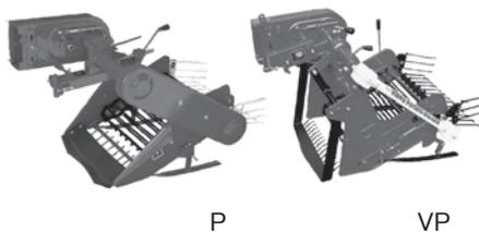
独自のコンベア技術により、傷つけることなく収穫物と土を分離するため、収穫が容易に行える
