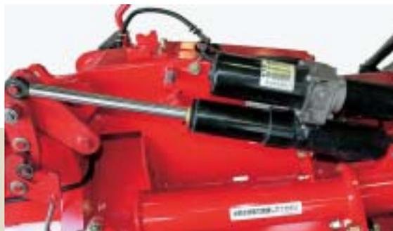
電源を切り忘れた場合でも、約8時間後は自動的に電源が切れるオートパワーオフを採用し、バッテリー上がりを防ぎます。
