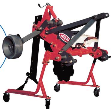
耕盤を破碎して圃場の透水性・通気性を改善させる作業機としてサブソイラーがあります。適応馬力が16~30馬力用のS28(1連、振動式)と適応馬力30~50馬力用のS228(2連、振動式)はすでに商品化されていましたが、大型トラクタ用が欲しいとのニーズから今年、SAM200(適応馬力40~60、2連、無振動)及びSAL200(適応馬力60~100、2連、無振動)SAL300(適応馬力70~120、3連、無振動)が商品化されました。シリーズ化することで、小型トラクタから大型トラクタまでお手持ちのトラクタで圃場の排水対策が可能になりました。
