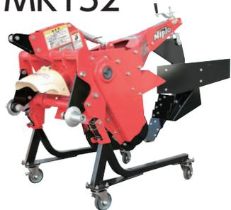
20~60馬力のトラクタで排水溝を作る機械として溝切機MK152があります。特に雪の深い地区で秋に排水溝を作っておくと雪解けが早まり、春作業にゆとりが持てます。
