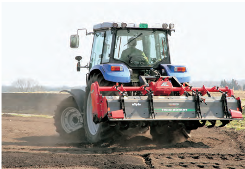
6枚爪仕様の畑作向けロータリー イセキJW120に装着
