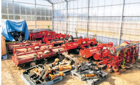
ロータリー 粘土質のため水分が多い時でも作業できるホルダータイプを使用
