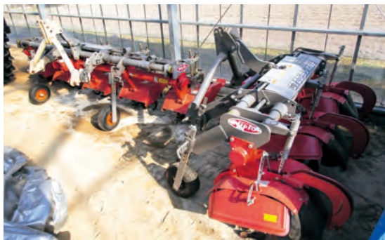
大豆の中耕管理にロータリーカルチを使用 RK511とRK305UV
