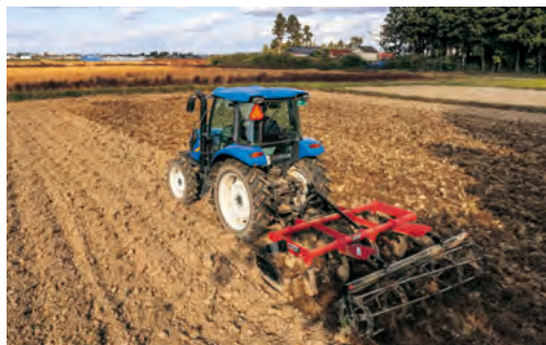
スピードカルチAPS2501での秋起こし作業 6~7km/hの高速作業で燃料代が約1/3の節約 深耕と荒耕して乾土効果による土づくり。
