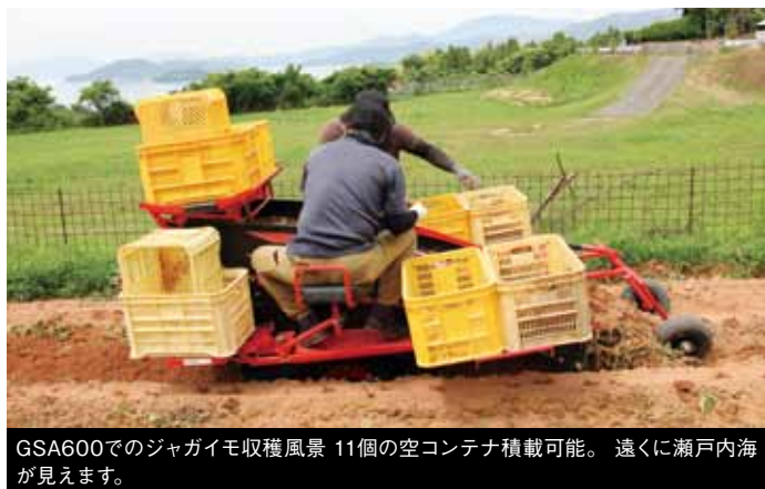
掘り上げたジャガイモを作業者が選別しながらコンテナへ収納します。機械操作と作業を一人で行うことができます。
