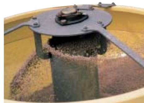
ホッパーに複数の単肥を投入し、100秒ほど駆動させます。ホッパー中央の縦軸オーガにより肥料を混合します。その後シャッターを開け、混合された肥料を散布します。
