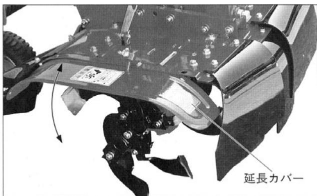
耕うん部カバーは、土寄せ、畝もりなどの土の吐き出し・飛びに応じてカバー全体が広く、大きく調整できます。
