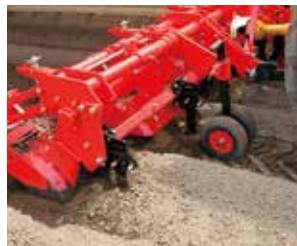
ゲージ輪をダブル(合計4ヶ)で作業深さが安定
